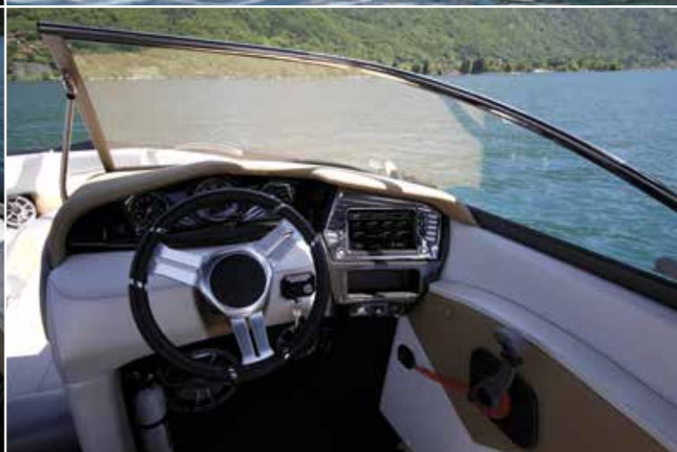
L'écran tactile déporté permet au pilote de contrôler rapidement tous les paramètres du bateau.
