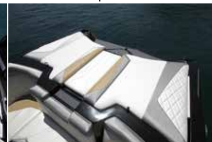
Le coussin central du bain de soleil se retourne pour libérer un accès vers la plage de bain.
